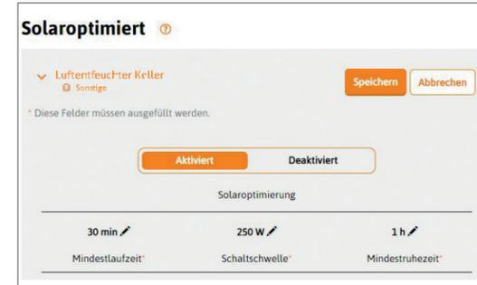
Soll die Verbrauchsstrategie für Geräte als Kombination aus Solaroptimierung und Zeitsteuerung erfolgen, bietet das EnergyManager Portal ebenso die Möglichkeit Zeitbereiche zu definieren, in denen die Solaroptimierung zwingend deaktiviert ist.
